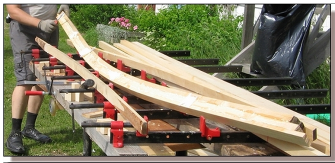
Viime kesänä tekemiämme portaiden koivuliimauksia. Työ perustui yksinkertaisesti siihen, että ruuvipuristimet oli kiinnitetty pöytään kaareeksi. Mäntyä ja kuusta voidaan kaarta huomattavissa määrin.
